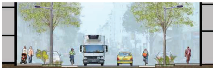
In alto: una prospettiva del corso; in basso: la sezione stradale tipo, dove si vede l'equa ripartizione degli spazi tra spazi pedonali, corsie ciclabili, e traffico automobilistico
